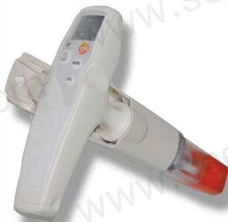
این محصول دارای درب پوششی ، حاوی ژل محافظ یا الکترولیت است در صورتی که پراب در مدت زمان طولانی درون ژل الکترولیت قرار نگرفته باشد باید کاربر الکترود را به مدت 2 ساعت در ژل الکترولیت قرار دهد تا الکترود دوباره احیا شود. درب پوششی حاوی ژل الکترولیت را می توان بر روی دیوار نصب کرد و بعد از هر بار اندازه گیری دستگاه را درون آن قرار داد. این دستگاه دارای ریل یا هولدر همراه است و قابل نصب بوسیله پیچ بر روی دیوار است.
