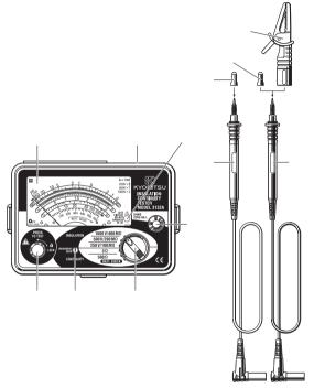
METER MOVEMENT ZERO ADJUST SCALE PLATE LIVE CIRCUIT LAMP RANGE SELECTOR SWITCH TEST PROBE (BLACK) EARTH PROBE TEST PROBE CAP(BLACK) TEST BUTTON
